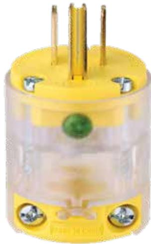
Fabricado en nylon amarillo con contactos de latón, incluye luz piloto LED verde para indicar alimentación. Diseño recto de dos polos, tres hilos y conexión a tierra. Soporta 15A y 125V, con conexión trasera para cables #18-12 AWG. Fabricado en nylon amarillo con contactos de latón.
